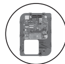
Reservdel som ska bytas ut: styrkort + plasthöljet, strömkort
